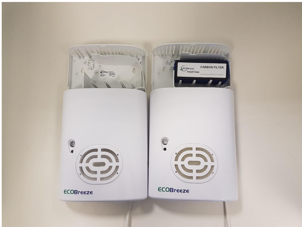
图 5: Ecobreeze 设备拆开照片，一台装有碳滤芯，一台不装（设备用于测试，处于关闭状态）
