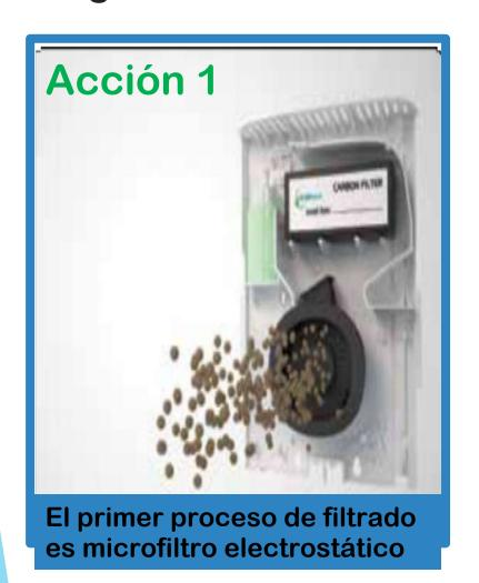
El aire maloliente es extraído del ambiente y enviado a través del microfiltro electrostático el cual está compuesto por un soporte bidimensional que permite la entrada de aire y está compuesto por una espuma polimérica reticulada con un tamaño de poro de 30 ppi. Especialmente diseñado para remover y retener partículas grandes como polvo, pelo y pólen
