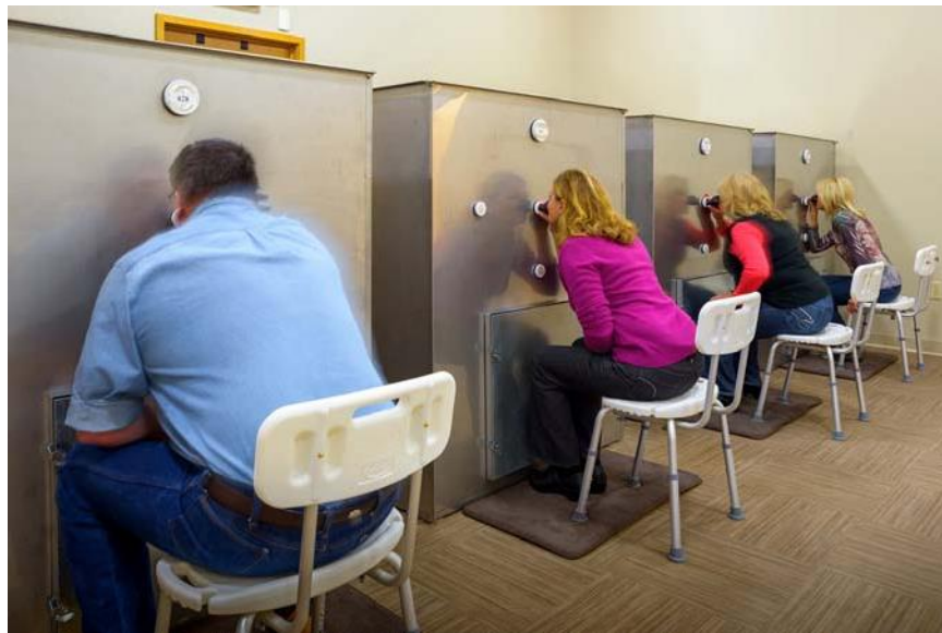
图1. St. Croix Sensory公司用于恶臭清除效果测试的4个不锈钢测试室。尺寸均为1.2×1.2×1.5米（2.16立方米、88立方英尺），前部中央带有一个嗅探窗口、多个测试接口，顶部有两处进气和排气口，前部还有舱门。每次测试结束时，使用顶部的排气系统来净化测试室。
