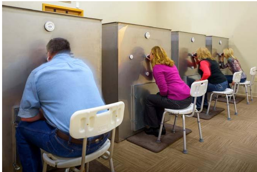
Figura 1. Cuatro de las cámaras de acero inoxidable que se utilizaron para la Prueba de eficacia en la reducción del mal olor fecal en St. Croix Sensory, Inc. Todas las cámaras son de tamaño idéntico 1.2x1.2x1.5m con un Puerto olfativo en la parte central del frente, en el frente También se ubicaron múltiples puertos test, dos puertos de acceso y escape en la parte superior, y la escotilla de acceso en el frente. El Sistema de evacuación en la parte superior de la cámara se utilizó para depurar la cámara al finalizar el test.
